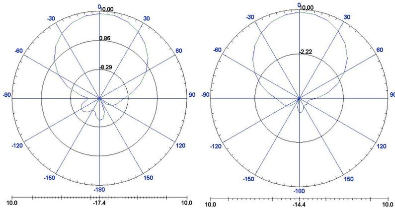
图7 天线方向图1 (E面)
