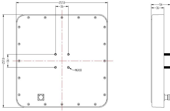
图2 安装尺寸图
