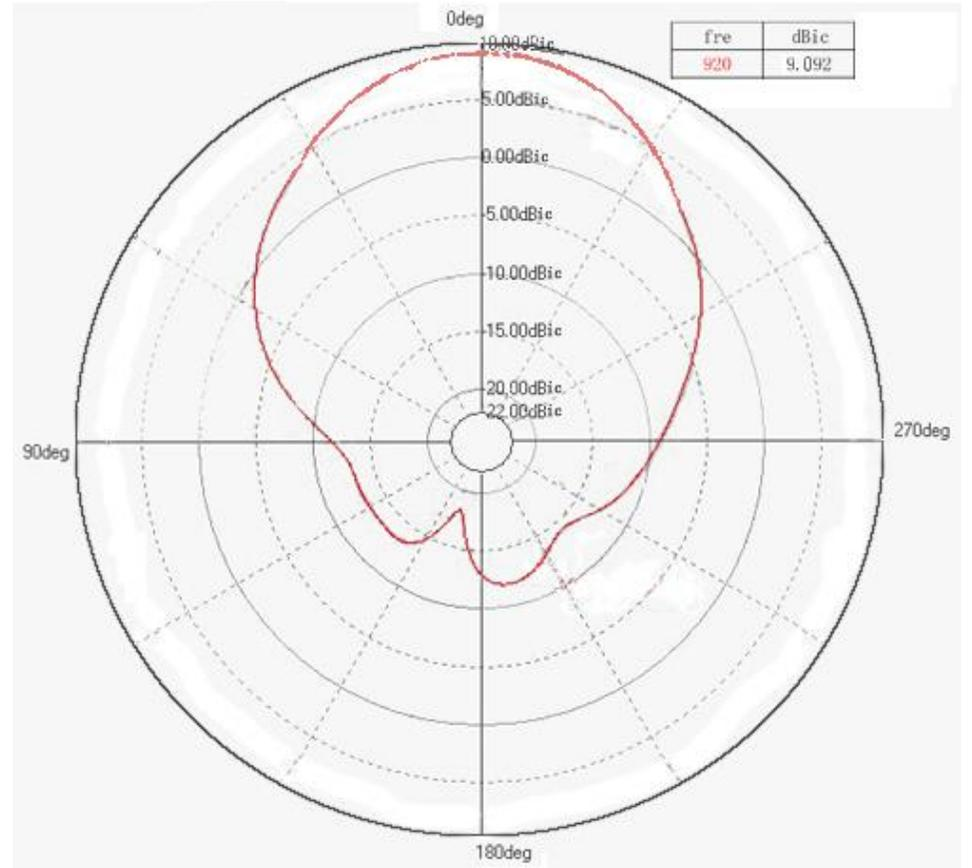
图9 天线2D方向图
